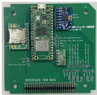
図 6-1：MB-1 衛星内環境測定ボード
