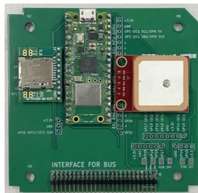
図 6-3：MB-3 GPS センサーボード
