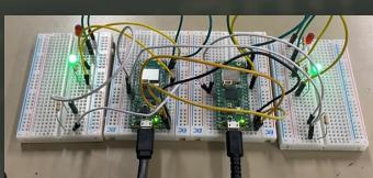
システムが予期しない動作をするので速やかにソフトウェアを修正しなければならない。そのためには、マイコンを電源リセットして、プログラムを再びメモリに読み直すことで対処できる。そこで、2台のマイコンが相互監視して、相手の異常を検知したときに相手を電源リセットする仕組みを作成した。この仕組みでは2つのマイコンが互いにハートビート（正常に動作していることを示す信号）を送り合い、ハートビートが送られてこなかつたら相手のマイコンでSEUによるソフトウェアエラーが発生したと判断し、相手のマイコンをリセットする。
