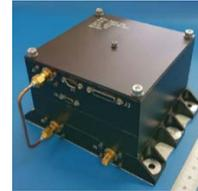
図 3-8 X-Band 送信機 (MTX-540X)<sup>9)</sup>
