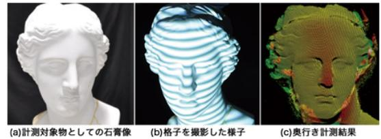
図 2.11: 格子投影法による石こう像の計測例
