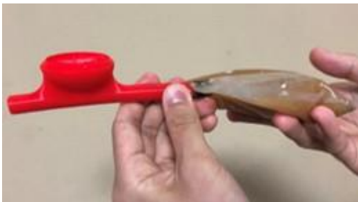
図 5.5 試作したスペースストローとパック（みそ汁を封入）
