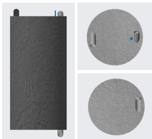
Fig. 4-3.1 シャワールーム外観 (←側面, ↑上面, ↓下面) ※上面下面の管はシャワーノズル・送風口の接続イメージ
