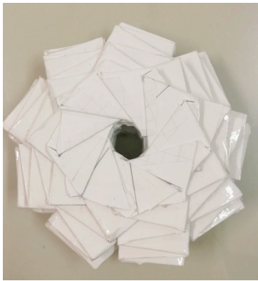
図5 中心軸から見た折り畳まれたソーラーシステム
