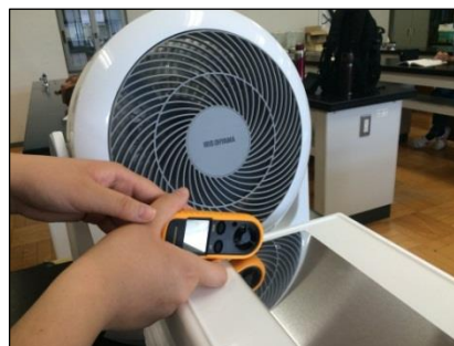
図2 風速の測定の様子
