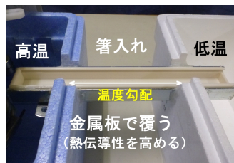
図6 温度勾配とプラナリアの分布を調べる装置
