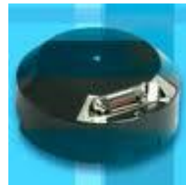
図 9-3 リングレーザージャイロ外観
