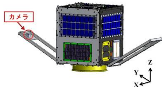
図 4.2 展開時 衛星外観図
