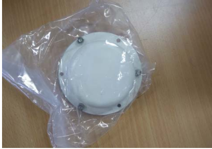
図11.4.2：パッチアンテナの外観 (SPRITE-SAT搭載のSバンドアンテナ)
