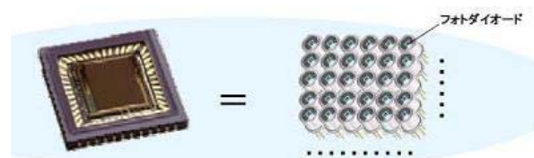
図1.3.3 : イメージセンサとフォトダイオード (VLCC HP)
