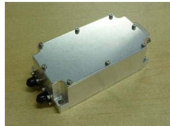
図11.4.1：送信機の概要 (SPRITE-SAT搭載のSバンド送信機)
