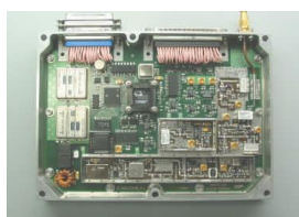
Fig. 10.3.2 S-band 送信機, 及びパッチアンテナ
