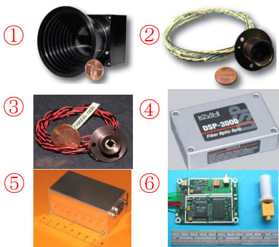
Fig. 7.3.1 各センサ ①ST[6] ②MSS[6] ③CSS[6] ④FOG[7] ⑤MS[8] ⑥GPSR[8]
