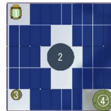
図 6-4 太陽電池セル貼り付けパターン( Z_{b+} 面) (1 は GPS, 2 は MST, 3 は HPM, 4 は SANT, その他は SA を表す)
