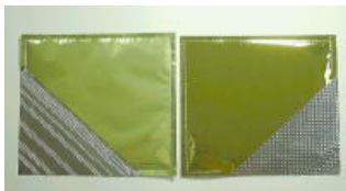
図 18-3 多層断熱ブランケット (宇部興産製)
