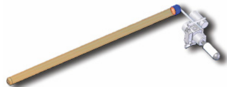
図 2-2 小型衛星用インフレータブルチューブ系概観
