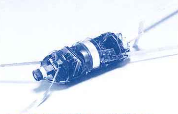
BottleSat (B-Sat) による流星群の立体観測【東北大】
