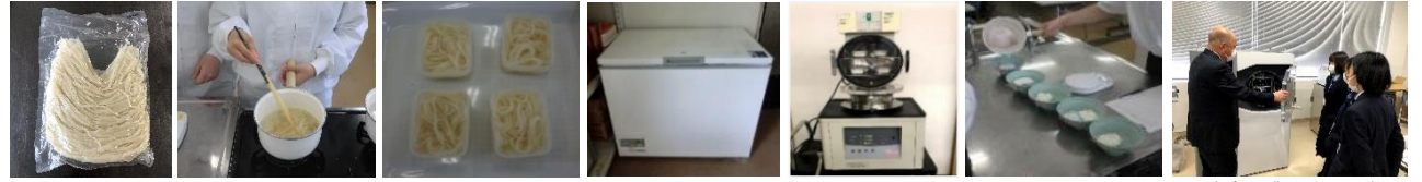
市販の米粉麺 → 麺の処理（湯煮） → 容器に分注 → -40℃で予備凍結 → 凍結乾燥機にかける → お湯戻しの調査 広島工業大学と連携教授より指導助言を頂く
