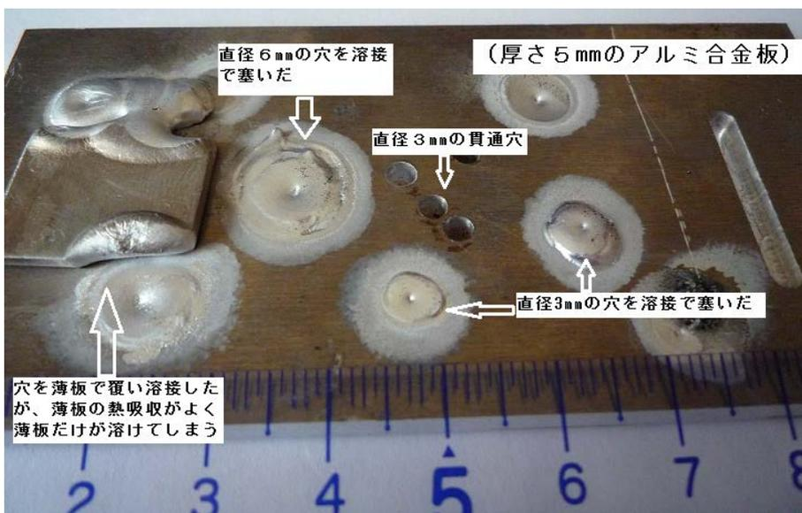
写真1 アルミ合金板の貫通穴を TIG 溶接で塞いだ様子
