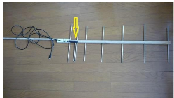
図 11 ワンセグチューナー組み込み自作八木アンテナ
