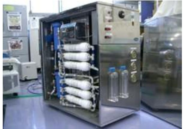
Fig.4-4.1 JAXA が開発中の水再生装置
