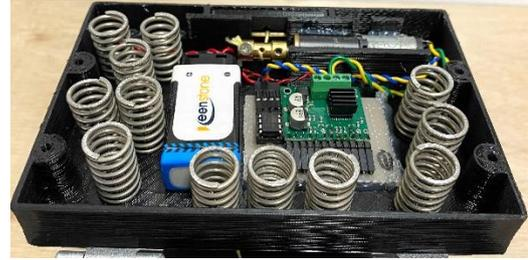
図 4.8 ばねを取り付けた面内部
