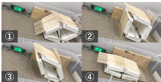
図4.2 斜°30°の軟弱地盤走行(珪砂5号)
